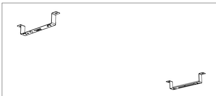
Montage au plafond avec QuickFix – Position de l'équerre QuickFix « outdoor ».
